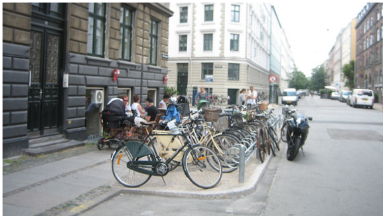
Места для парковки велосипедов, созданные за счет сужения улицы и расширения зоны тротуара, также имеют функцию замедления транспортного движения и сокращают длину пешеходной дорожки.
