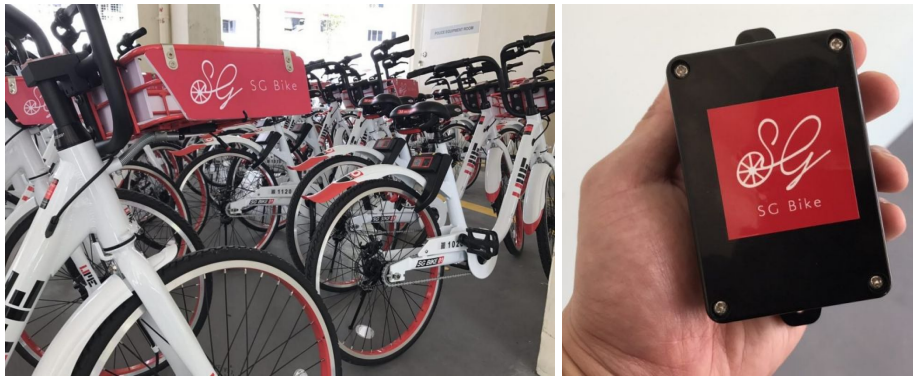
Gambar 18: SG Bike dari Singapura menggunakan peranti “geostation” dengan teknologi RFID untuk memastikan pengguna sepedanya hanya bisa memarkirkan sepeda di tempat yang telah ditentukan (sumber: The Straits Times - sgsme.sg )
