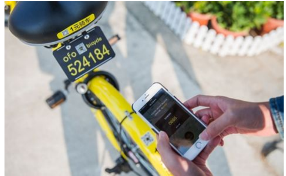
Gambar 1: Proses membuka kunci ( unlocking ) sepeda DBS dengan pemindaian kode QR (sumber: ofo.com )
