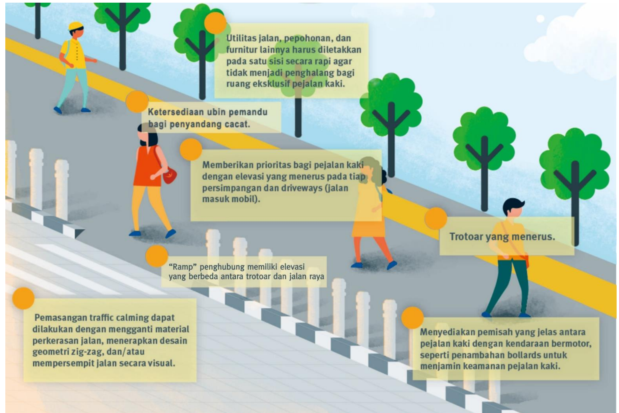
Gambar 3. 1 Ilustrasi komponen pada trotoar (ITDP, 2017)
