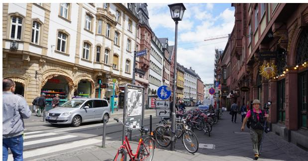
Sementara peletakan tiang rambu dan/atau papan informasi ini diletakkan di luar ruang bebas pejalan kaki. Disarankan diletakkan di ruang utilitas dan/atau buffer. Pemilihan lokasi didasarkan pada kebutuhan atau kondisi masing-masing ruang jalan.
