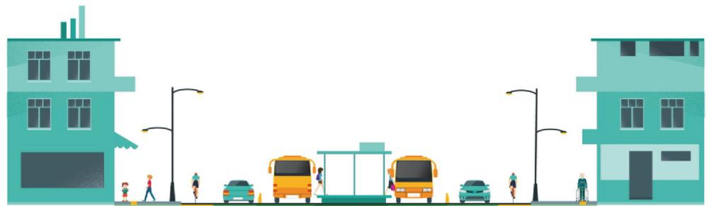
Pada potongan jalan dengan halte bus di tengah dan lebih lebar, dapat ditambahkan 1,5 meter masing-masing jalur sepeda di kedua sisi. Trotoar minimal dipertahakan dengan lebar 2 meter bebas dari gangguan.
