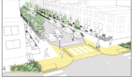
Intervensi pada akses masuk dengan raised crossings Sumber: NACTO
