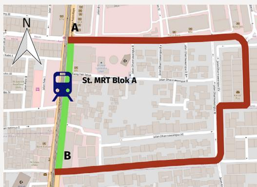
Peta di kiri menggambarkan rute yang berbeda bagi kendaraan bermotor dengan sepeda untuk menempuh perjalanan dari titik A ke titik B. Saat ini, hanya arus kendaraan dari Selatan ke Utara yang dilayani. Kendaraan bermotor harus menempuh perjalanan sekitar 1.2 km dari A ke B, digambarkan dengan garis merah.
