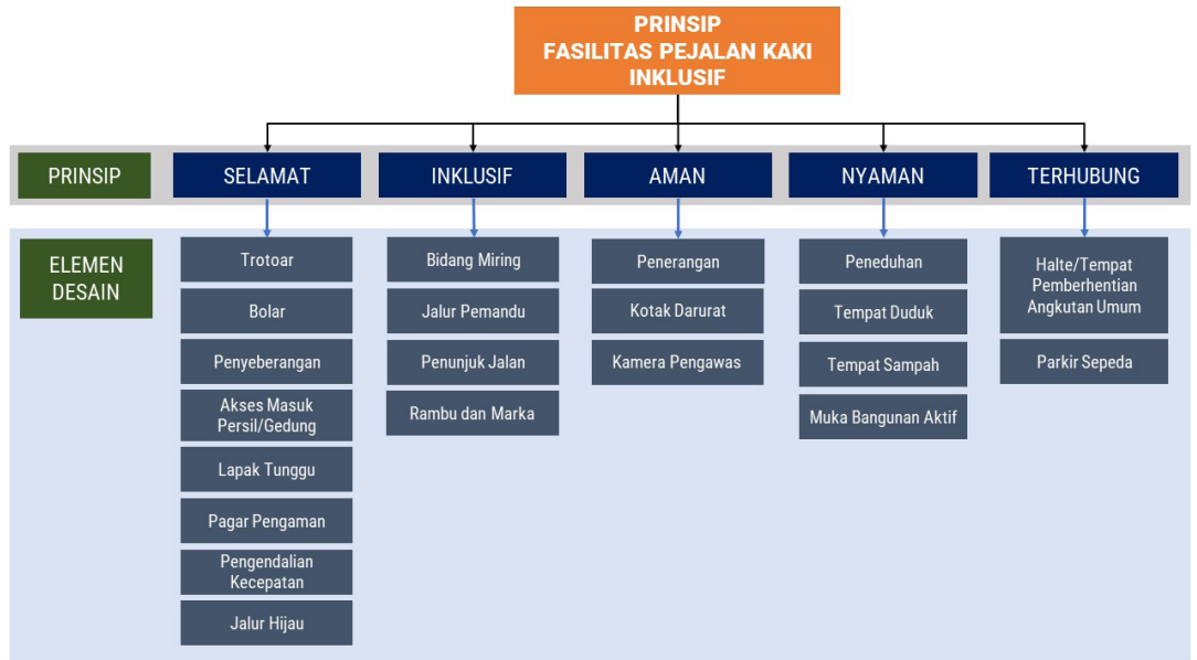
Gambar 114. Bagan pembagian prinsip fasilitas pejalan kaki inklusif serta turunannya dalam bentuk elemen desain
