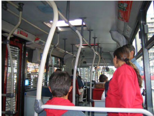
Gambar 80: Tiang Vertikal Sebagai Pegangan Tangan (Sumber: ITDP)
