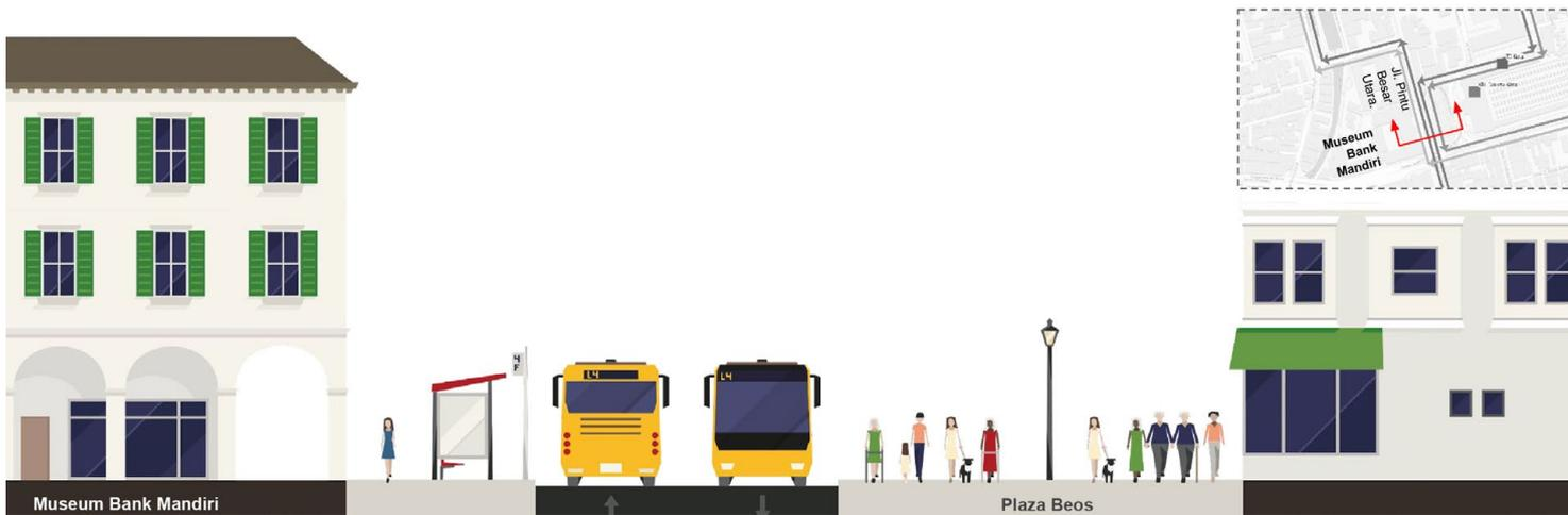
**Gambar 39. Potongan Konfigurasi Ruas Jalan di Depan Museum Bank Mandiri dengan Penambahan Bus Stop/ Halte (Menghadap Utara)**
