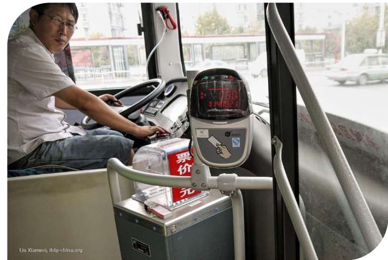
Mesin tap-in dan tap-out untuk pembayaran non-tunai di dalam bus
