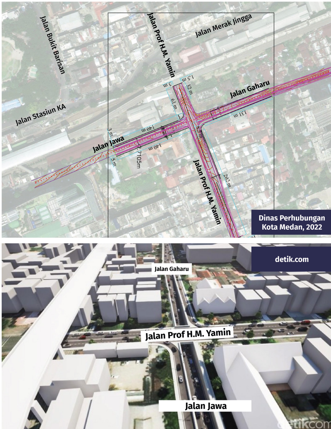
Gambar 2.9 Gambar rencana awal dan ilustrasi underpass Simpang Gaharu/H.M. Yamin (Dinas Perhubungan Kota Medan (2022), detik.com)
