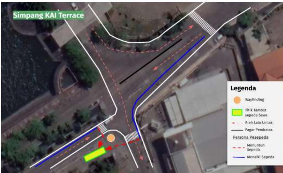
**Gambar 6.14 Ilustrasi aksesibilitas dari dan menuju titik tambat titik tambat sepeda sewa pada Simpang KAI Terrace**
