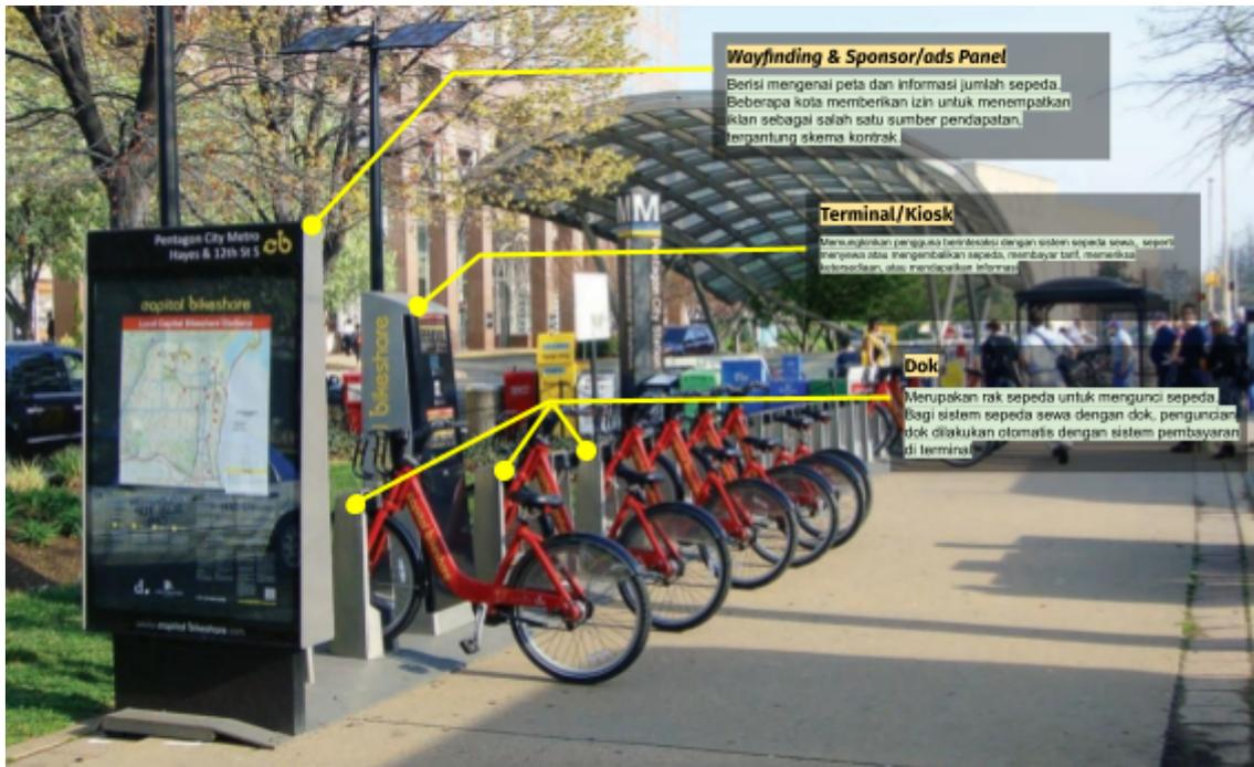
**Gambar 5.3 Aset pada layanan sepeda sewa dengan dok**
