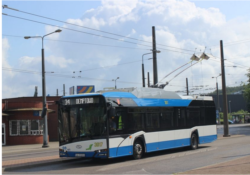
Gambar 12. Penggunaan In-motion charging untuk bus troli di Gdynia, Polandia
