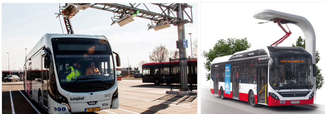
Gambar 11. Penggunaan pantograph up di Bandar Udara Schiphol Amsterdam (kiri) dan penggunaan pantograph down di Hamburg, Jerman (kanan)
