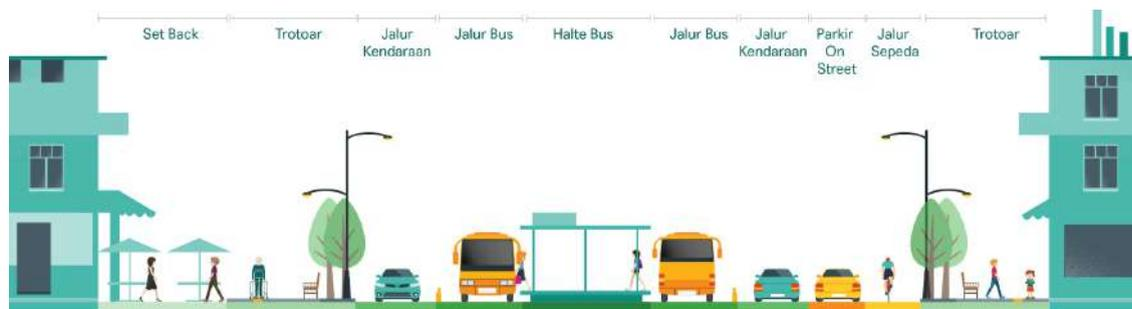
Gambar 65 Ilustrasi Konsep Complete Street (Sumber: ITDP, 2020)
