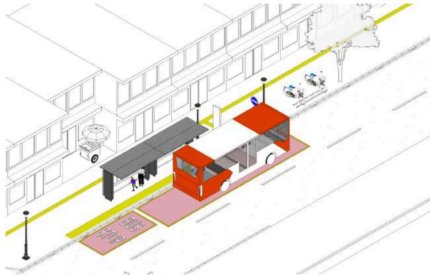
Gambar 93 Ilustrasi Halte Bus dengan Dua Subhalte yang Melayani Bus Besar dan Minibus
