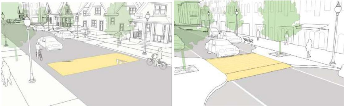
Gambar 85 Ilustrasi Permukaan Jalan yang Ditinggikan: Speed Hump (Kiri) dan Speed Table (Kanan) untuk Mengurangi Laju Kendaraan (Sumber: NACTO, 2013)
