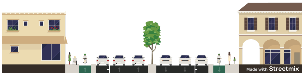
Gambar 37. Tipologi 25 meter dengan Parkir Dua Sisi
