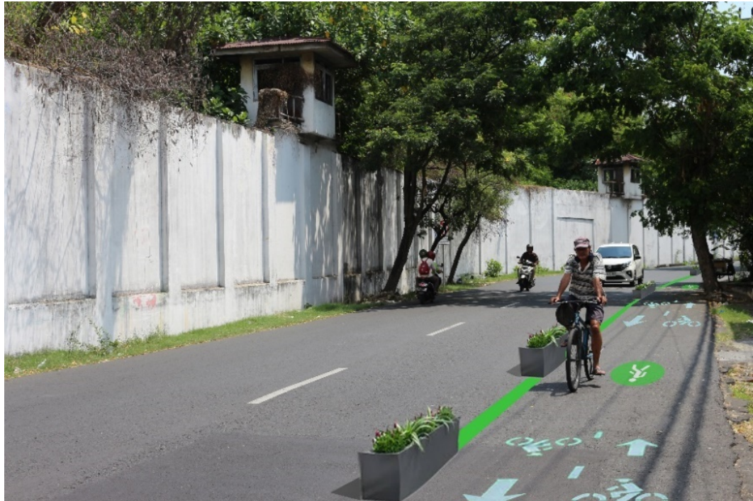
Gambar 64. Ilustrasi Rancangan Jalur Sepeda dan Pejalan Kaki dengan Proteksi Pot Tanaman di Jalan Kutilang
