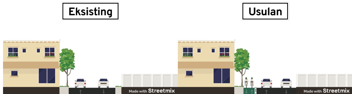
Gambar 63. Potongan Melintang Eksisting dan Usulan Intervensi Temporer di Jalan Kutilang
