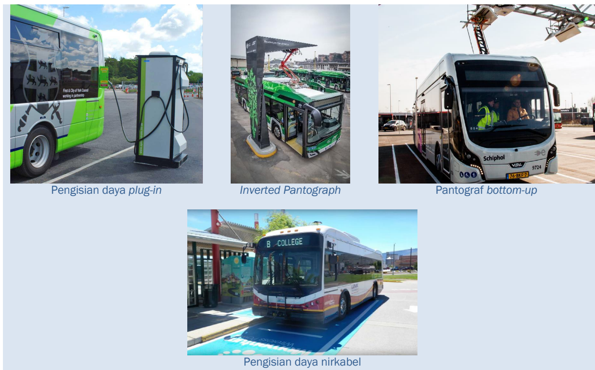
Gambar 7. Pengisian Daya Plug-in 27 (Kiri Atas), Inverted Pantograph 28 (Tengah Atas), Bottom-Up Pantograph 29 (Kanan Atas), dan Nirkabel 30 (Bawah)
